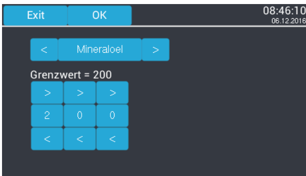
Bild 14 - Displayansicht zur Auswahl der Isolierflüssigkeit und Parametrierung des H 2 -Grenzwertes
