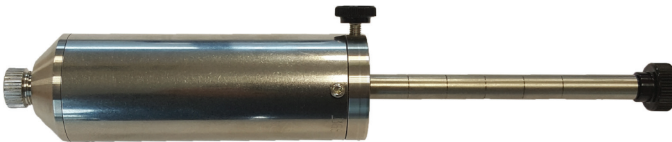
Bild 20 - BGS mit vollständig ausgezogener Kolbenstange
