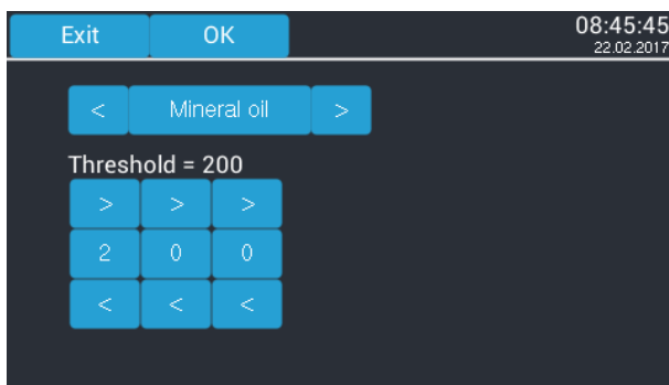
Figure 13 - Affichage d'écran pour sélectionner le liquide diélectrique et pour paramétrer la valeur limite H 2
